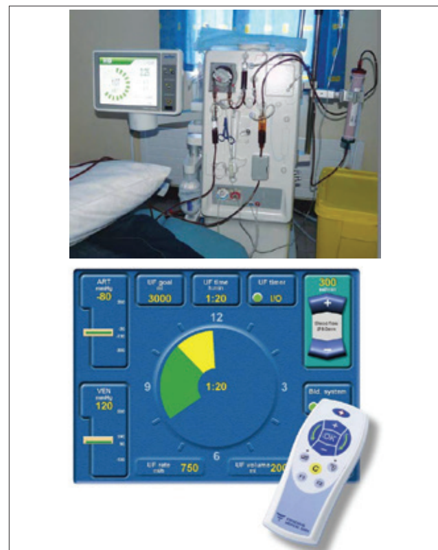
Obr. 2: Úprava klasických HD přístrojů pro DHD: přesun ovládacího panelu na pohyblivé rameno (firma Nikkiso) – horní část obrázku; dálkové ovládání přístroje (firma Fresenius) – dolní část obrázku.
